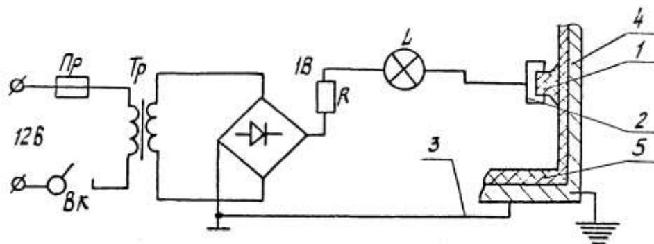
1 - поролоновая вставка щупа; 2 - щуп; 3 - провод заземления; 4 - корпус аппарата;
